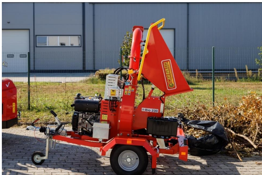
Nagyteljesítményű ágaprító gép: metszési, fakivágási munkák után keletkező gallyak, ágak helyben történő aprítására, komposztálására vagy elszállítására való előkészítésre szolgál.
